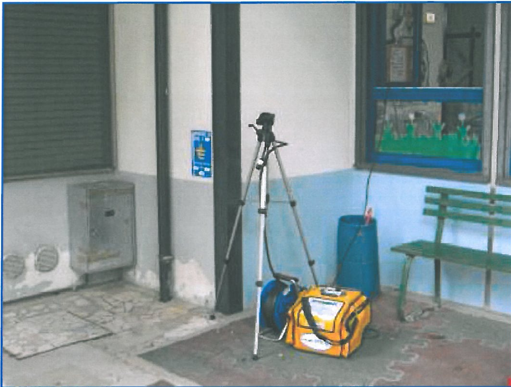
Foto 7 SEM N° 1 - Monitoraggio ambientale effettuato nel cortile interno, di fronte all'ingresso della scuola
