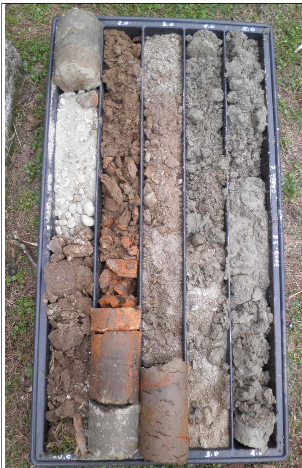
Foto 3 – Sondaggio S1 – cassetta n. 1: 0.00 – 5.00 m.
