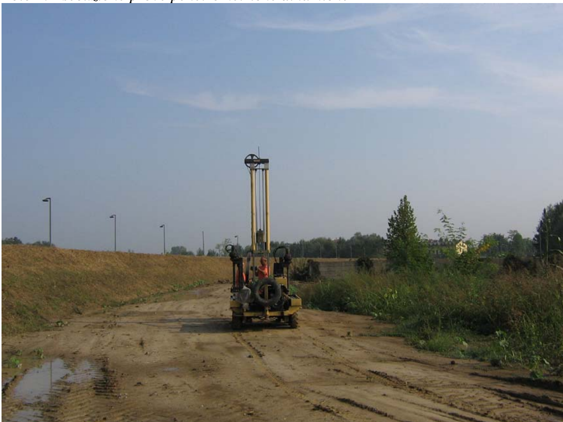
Foto 2. Esecuzione prove penetrometriche dinamiche
