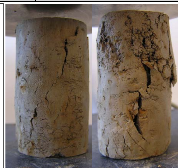
Curva Sforzi-deformazioni (foto a sinistra) e fase finale della prova dopo la rottura del campione (foto a destra)
