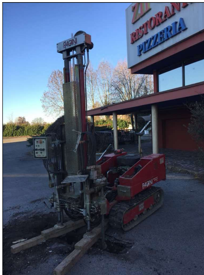
Prova penetrometrica statica (CPT) n.4.
