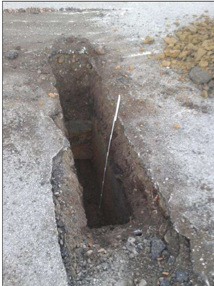
Foto 3 - Pozzetto esplorativo TC.
