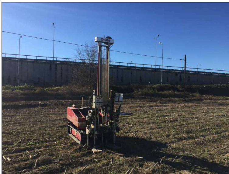
Prova penetrometrica statica (CPT) n.2.
