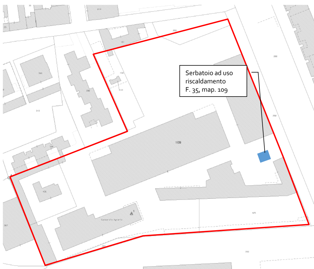
Figura 11 – Stralcio mappa catastale con posizione serbatoio interrato uso riscaldamento
